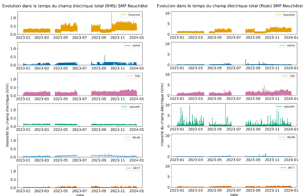
Figure 30: évolution de l'intensité de champ électrique des mesures permanentes stationnaires pour l'année 2023 sur le site G+P de Neuchâtel, regroupée par catégorie de source. La partie gauche du graphique montre les valeurs RMS et la partie droite montre les valeurs de Peak correspondantes. Les courbes d'intensité de champ des autres stations de mesure sont présentées en annexe. V, aux Figure 48 - Figure 51.
